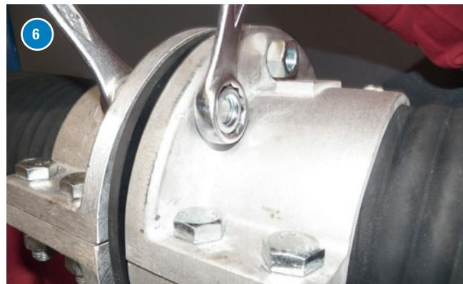
Положите прокладку по возможности концентрично между фланцами. Плотно завинтите фланцы друг с другом. Герметичность обеспечивается только давлением поверхности среза шланга на прокладку.
